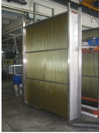
Şekil 6.1: Şekil 6.2: Türbin giriş havası soğutma ünitesi soğutma bataryası, imalat sürecinden görüntü
